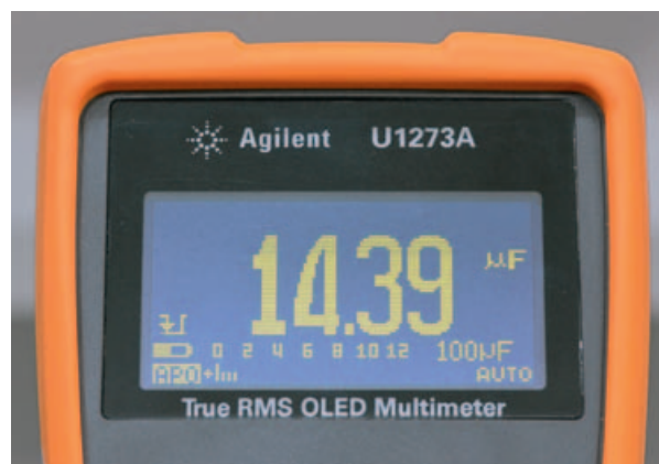
Bild 4: Der gleiche 20-µF-MLCC aus Bild 2 mit der Kapazitätsmessfunktion eines Digitalmultimeters gemessen. Die Abweichung zum tatsächlichen Kapazitätswert ist hier noch einmal größer.
