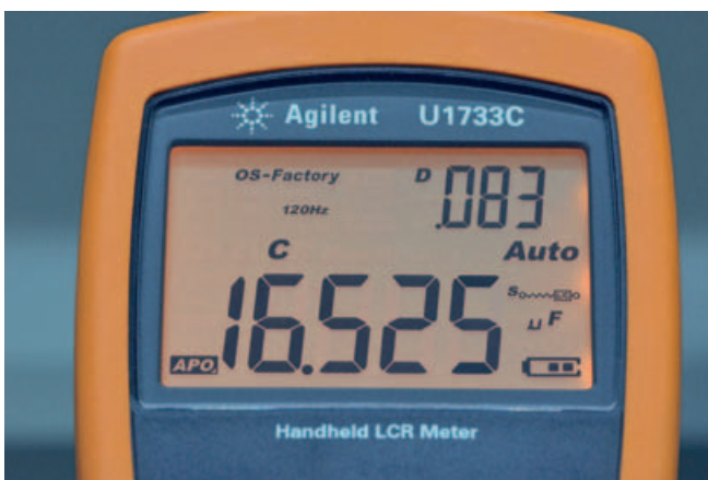
Bild 2: Ein Klasse-2-MLCC mit dem Sollwert 20 \mu F, geprüft bei 120 Hz mit zwei verschiedenen LCR-Messgeräten. Auch hier kommt es, bedingt durch die bei 20 \mu F zu geringe Prüfspannung des Handheld-Testers zu gravierenden Messabweichungen nach unten (links). Dagegen ermittelt die LCR-Mesbrücke korrekte Werte (rechts).
